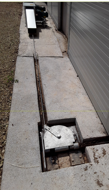
Stabile Umlenkrollen für verschiedene Montagesituationen, seilschonend eingebaut.
