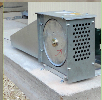
Robuste Antriebswinde am Boden montiert.
